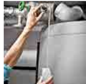
5 Abfüllung einer Trinkwasserprobe zur Analyse im Labor
