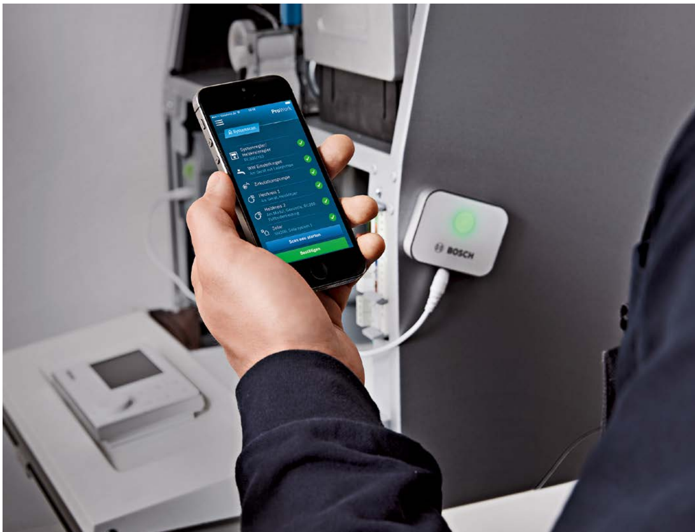
Digitale Heiztechnik hat nicht nur Vorteile für Wohnungsunternehmen und Mieter: Apps und Tools helfen ebenso dem Installateur, sowohl während der Inbetriebnahme als auch bei Wartungsarbeiten
