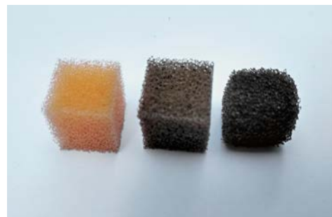
Schaumstoffwürfel als Trägermaterial für die Biologie in den Behältern der Aufbereitungsanlage. Links fabrikneu, mittig und rechts mit Bewuchs in getrocknetem Zustand nach 16 Jahren ununterbrochenem Betrieb in einer Berliner Anlage, die im Wirbelbettverfahren Grauwasser reinigt
