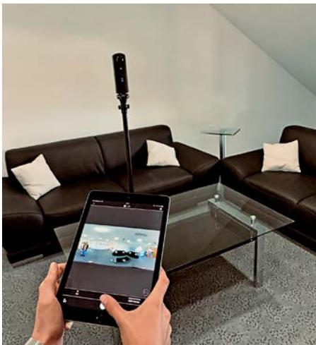
Fernsteuerung per App: Die 360-Grad-Kamera wird aus dem Nebenraum mit einem Tablet oder Smartphone bedient, um die Fotos für den virtuellen Rundgang zu erstellen
