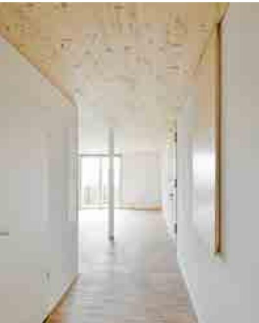
Im Innenausbau wurde Brettsperrholz aus Fichte für Decken und tragende Innenwände verwendet
