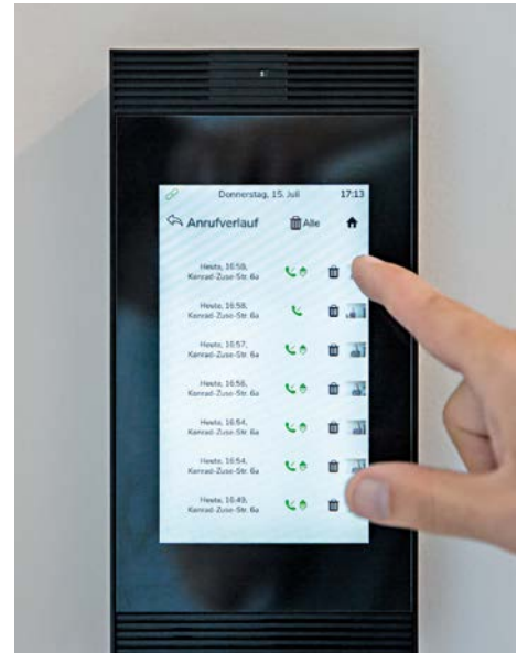
Mit dem Port-Terminal in den Wohnungen des Future Living Berlin lässt sich nicht nur der Aufzug rufen, sondern auch die Haustür öffnen
