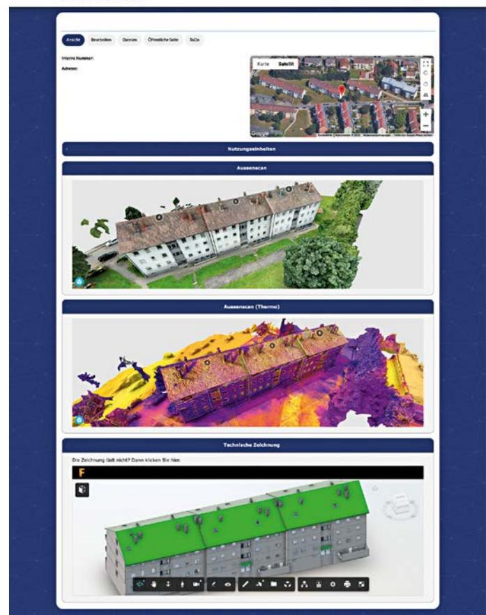
Übersicht der Digitalisierungsmöglichkeiten von Gebäuden (von oben nach unten): RGB-Scan, Thermografie-Scan, BIM-Modell
