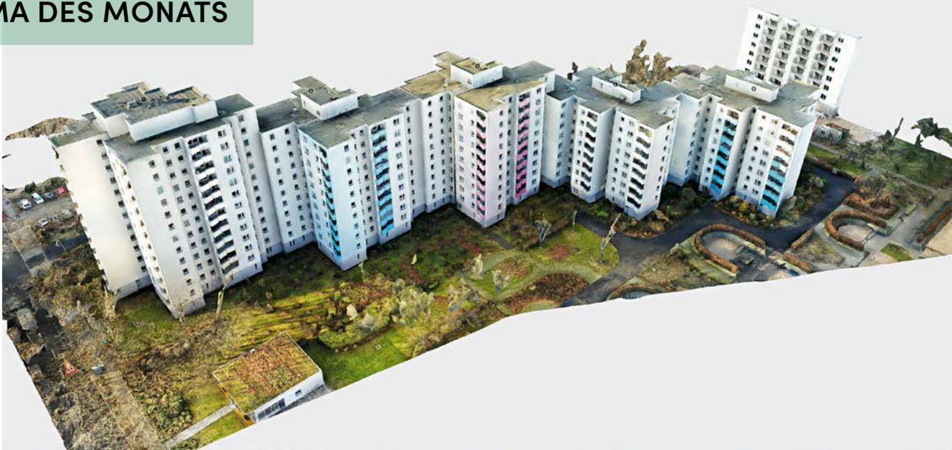
Übersicht eines gescannten Portfolios als 3D-Modell. Zur Erstellung werden Drohnen verwendet. Aus den Scan-Daten werden auch Punktwolken für den Außenbereich ermittelt, aus denen konkrete Maße abgeleitet werden können
