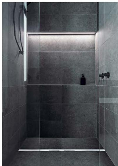
Alle Varianten der Duschrinne können über die gesamte Breite oder direkt an der Wand eingebaut werden
