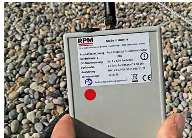
In Verbindung mit einer Funkeinheit können die gemessenen Daten auf einen Server geladen werden; im Falle eines Wassereintruchs kann auch ein Alarm ausgelöst werden
