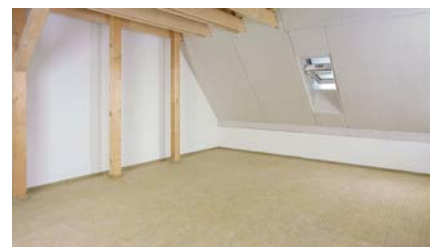
Die offenporige Struktur und das Federungsvermögen der Platten aus Steinwolle sorgen für eine Reduzierung von Luft- und Trittschall
