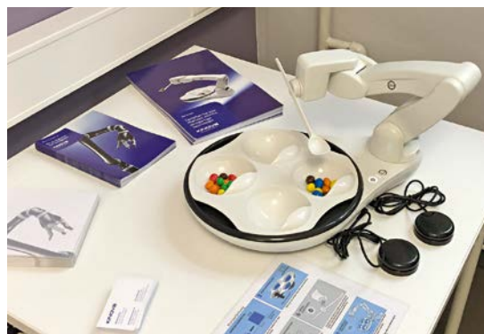
Essroboter ermöglichen es Menschen mit eingeschränkter Armmotorik, im eigenen Tempo und selbstbestimmt ohne Assistenz essen zu können
