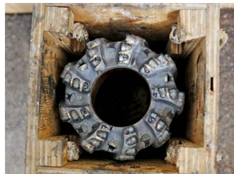
Kernkronen des Bohrkopfs, der für Tiefengeothermie-Bohrungen in Schwerin eingesetzt wurde
