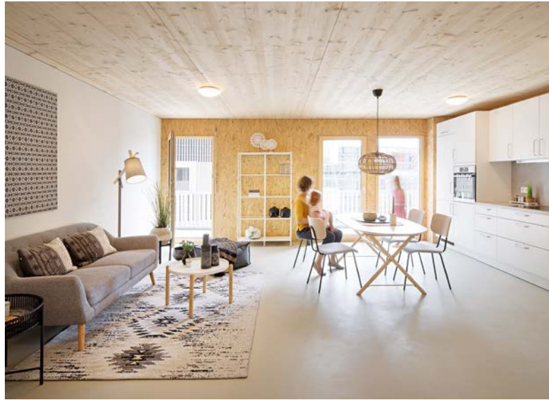
Die Wohnungen sind ansprechend ausgestattet inklusive einer hochwertigen Einbauküche. Die Oberflächen sind so gestaltet, dass vor Ort keine Beschichtung notwendig ist, mit Ausnahme des Fußbodens
