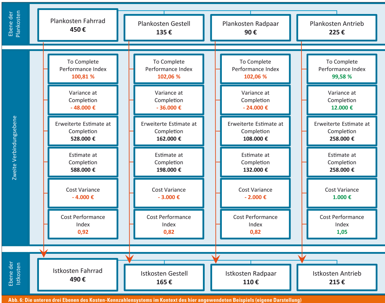
Abb. 6: Die unteren drei Ebenen des Kosten-Kennzahlensystems im Kontext des hier angewendeten Beispiels (eigene Darstellung)
