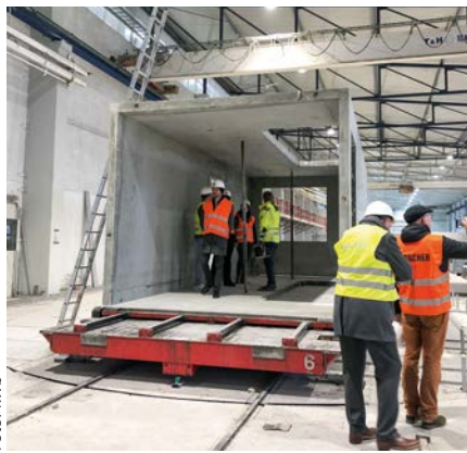
Die Raum-Module werden in Massivbauweise im Werk der Lechner Group vorproduziert...
