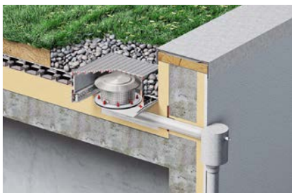
Das Regenwasser wird durch die definierte Drossel des Retentionsaufsatzes zeitverzögert in den Ablauf eingeleitet
