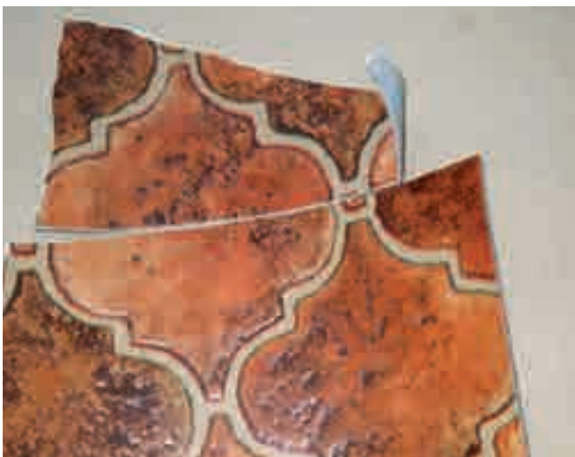
Cushion-Bodenbelag mit Asbestpappe auf der Rückseite
