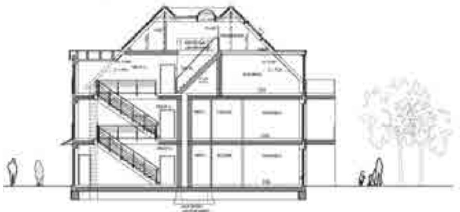
In Soltau entstehen Typenbauten für verschiedene Bauherren - u.a. diese Stadtvilla für die WGS mit Walmdach und sechs Wohnungen mit ca. 67 bis 91 m 2 Wohnfläche. Die Bauten weisen eine kontrollierte Lüftungsanlage mit Wärmerückgewinnung, Fußbodenheizung, einen Aufzug sowie Carports auf
