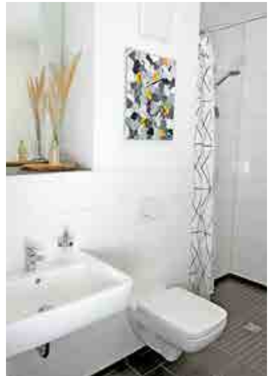
Bereits ab Werk waren die Einzelmodule mit Fenstern, Türen, Bodenbelägen und der Sanitärausstattung ausgerüstet
