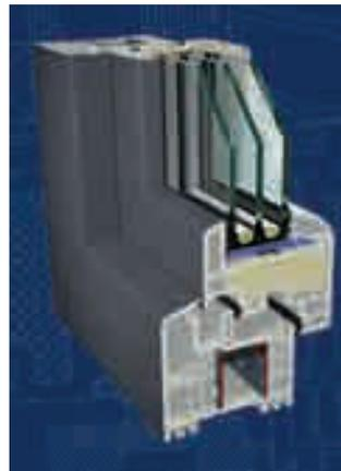
Eine gute Wärmedämmung erreicht das System Isola Secur durch die Doppelausschäumung von Flügel und Blendrahmen. Die Fenster sind auch in einer Ausführung mit hohem Einbruchschutz erhältlich. In den Blendrahmen wird beim Ausschäumen ein Flachstahl eingebracht, an dem die Schließteile sicher fixiert werden. So wird eine Widerstandsfähigkeit gegen Einbruchsversuche erreicht, die der europäischen Norm RC 2 N bzw. RC 2 entspricht und die zertifiziert ist. Das System ist auch in
