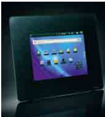
Auf solchen Wohnungsterminals können 30 Mieter künftig ihre Verbräuche in Echtzeit prüfen. Quelle: Archos
