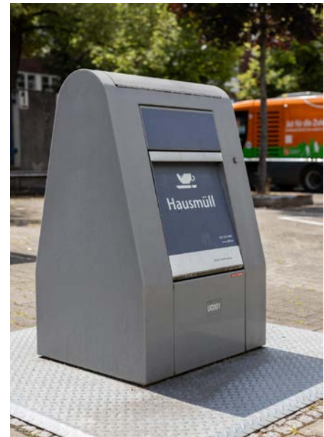
Unterflur-Müllsysteme lassen sich besonders bei Neubauten realisieren, können aber auch für bestehende Wohnquartiere eine Option sein
