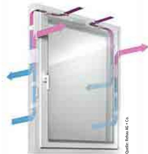
Komfortabel und energieeffizient Lüften mit bis zu 68% Wärmerückgewinnung
