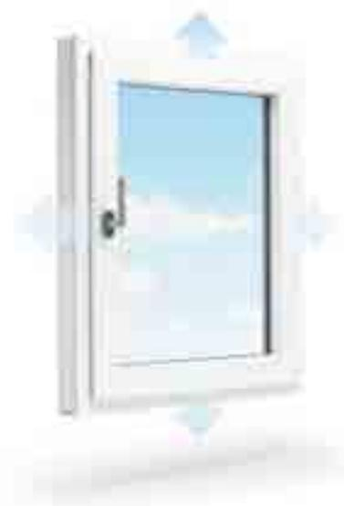
Die ideale Kombination aus Schließen und Öffnen für moderne Gebäude. Das Fenster im „geschlöffneten“ Zustand stellt den Flügel rund 6 mm vom Rahmen ab. Damit ist es offen genug für eine kontinuierliche Frischluftzufuhr, um Schimmel zu vermeiden und ein gesundes Raumklima zu erhalten. Gleichzeitig ist es geschlossen genug für Einbruchhemmung, Schallreduzierung und Energieeffizienz.
