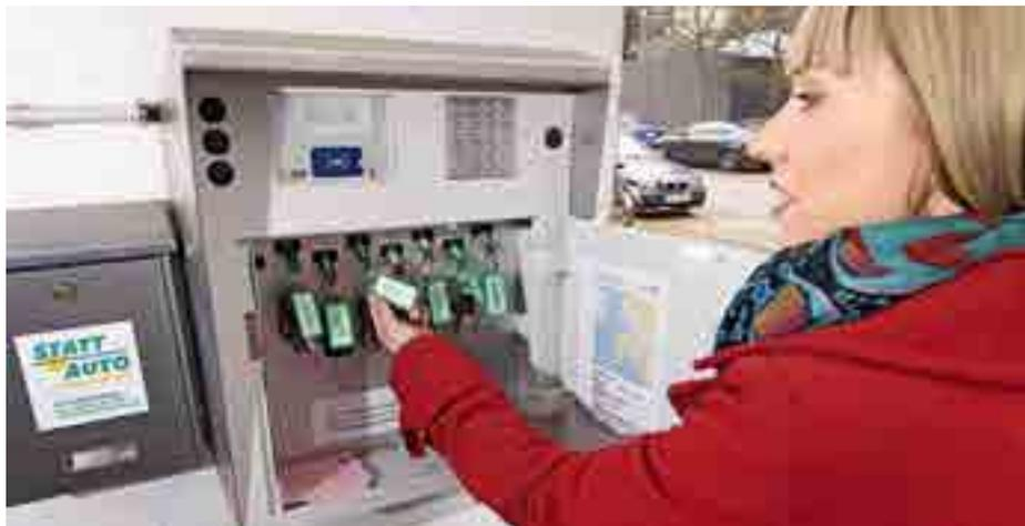
Die Schlüssel sind in einem Tresor hinterlegt, den die Nutzer mithilfe einer Karte öffnen können
