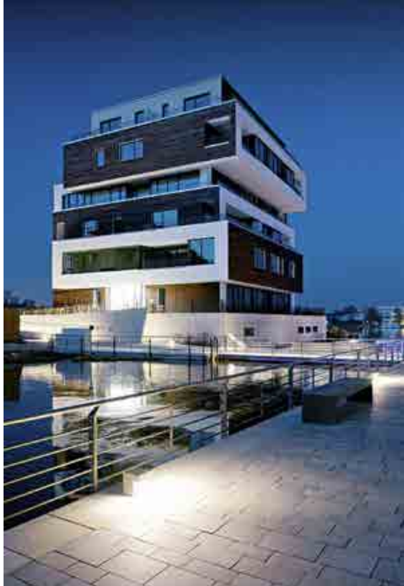
Bild oben: Beim Berliner Quartier „52 Grad Nord“ übernehmen kompakte LED-Bodenaufbauleuchten mit bandförmiger Lichtstärkeverteilung aus geringer Lichtpunkthöhe die blendfreie Beleuchtung der Bodenflächen. Bild links: Derart lichte Durchgänge gibt es nicht überall. Die Verbindung von Straßenraum und Hof per Licht funktioniert auch eine Nummer kleiner
