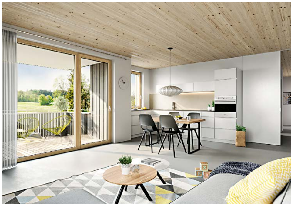
Die Deckenunterseite in Holz bleibt in den 21 Mietwohnungen sichtbar. Holz-Aluminium-Fenster runden das Holzbaukonzept ab
