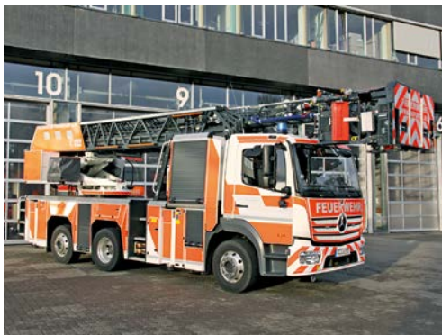
Drehleiterfahrzeug (DLK 23-12) für den zweiten Rettungsweg
