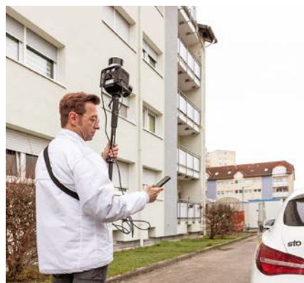
Digital und mobil: Vor Ort werden alle Details eines Gebäudes mit einem Laserscanner erfasst
