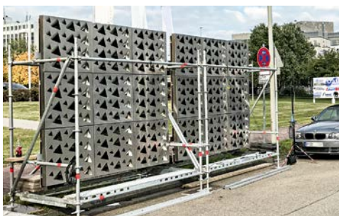
Energieerzeugung, Klima- und Lärmschutz stehen bei Fassadenlösungen mehr und mehr im Fokus. Bild zweier schallschluckender Akustikfassaden-Testelemente
