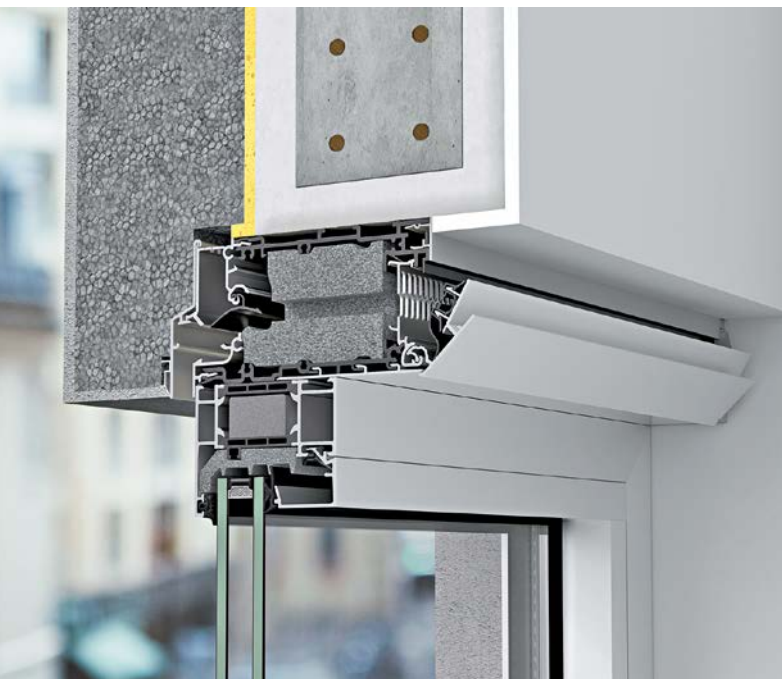
Das Fenster „Schüco VentoFrame Asonic Comfort“ ist mit einer selbstregulierenden Außenklappe und einer manuell bedienbaren Innenklappe zur individuellen Optimierung des Luftstroms ausgestattet. Der schalldämmende Schaum sorgt für eine effiziente Lärmreduktion
