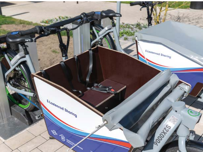
Die Box der E-Lastenräder trägt bis zu 60 kg und ist auch für den Transport von Kindern geeignet
