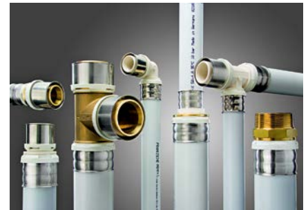
Die Verbindungsstücke bestehen aus PPSU sowie bleifreiem und entzinkungsbeständigem Messing, die Hülsen aus Edelstahl
