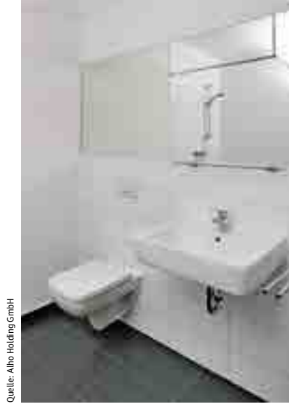
Im Modulbau werden die Bäder bereits ab Werk gefliest und mit Sanitärausstattung ausgerüstet
