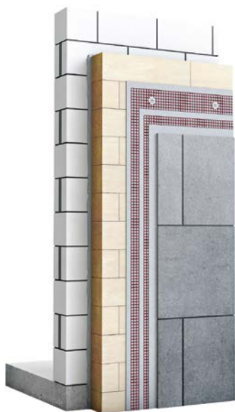
Die Lösung aus Keramik und Wärmedämmverbundsystem ist – im Vergleich zu einer vorgehängten Fassade – extrem wärmebrückenarm
