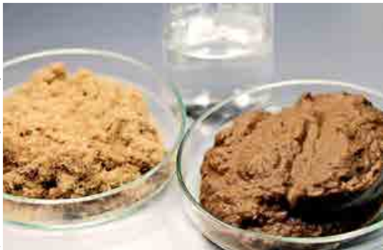
Holzfasern und Wasser liefern eine schäumbare Holzfasermasse
