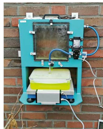
Bild 2: Das Wasser-Aufnahme-Messgerät (WAM) berechnet mit einer Software den Wasseraufnahmekoeffizienten (W-Wert)
