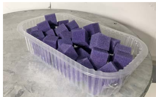
Mit diesen Schwämmen wird das Grauwasser gereinigt
