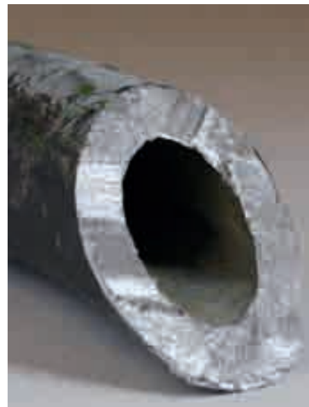
Gealterte Bleileitungen sind grau (l.). Im Anschnitt kommt das blanke, glänzende Blei zur Geltung
