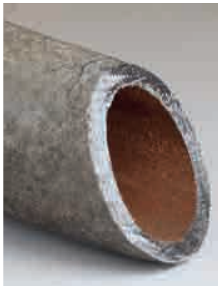
Gealterte Bleileitungen sind grau (l.). Im Anschnitt kommt das blanke, glänzende Blei zur Geltung
