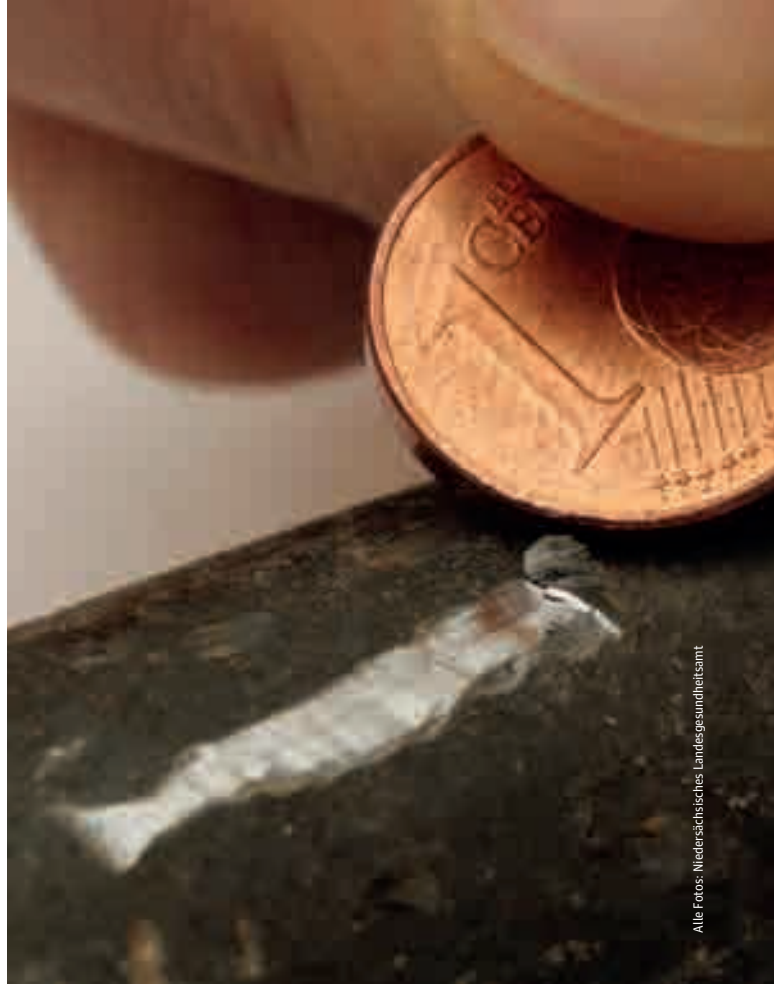
Bleirohre sind weich und lassen sich z. B. mit einer Münze einritzen. An der eingeritzten Stelle glänzt dann das blanke Blei
