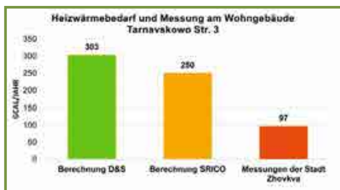
Grafik 6: Darstellung des berechneten Wärmebedarfs des Ingenieurbüros Drees & Sommer (D&S) und des staatlichen Bauinstituts der Ukraine (SRICO) im Vergleich mit den angegebenen Messungen der Stadt Zhovkva
