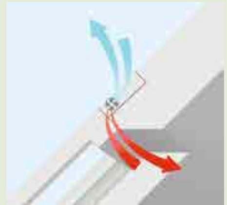
Lüfter für Standard-Dachfenster mit Wärmerückgewinnung
