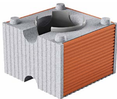
Die Schalungssteine werden sowohl für Mauerwerksstärken von 365 mm wie auch von 425 mm sowie in einer passenden Höhe von 250 mm angeboten
