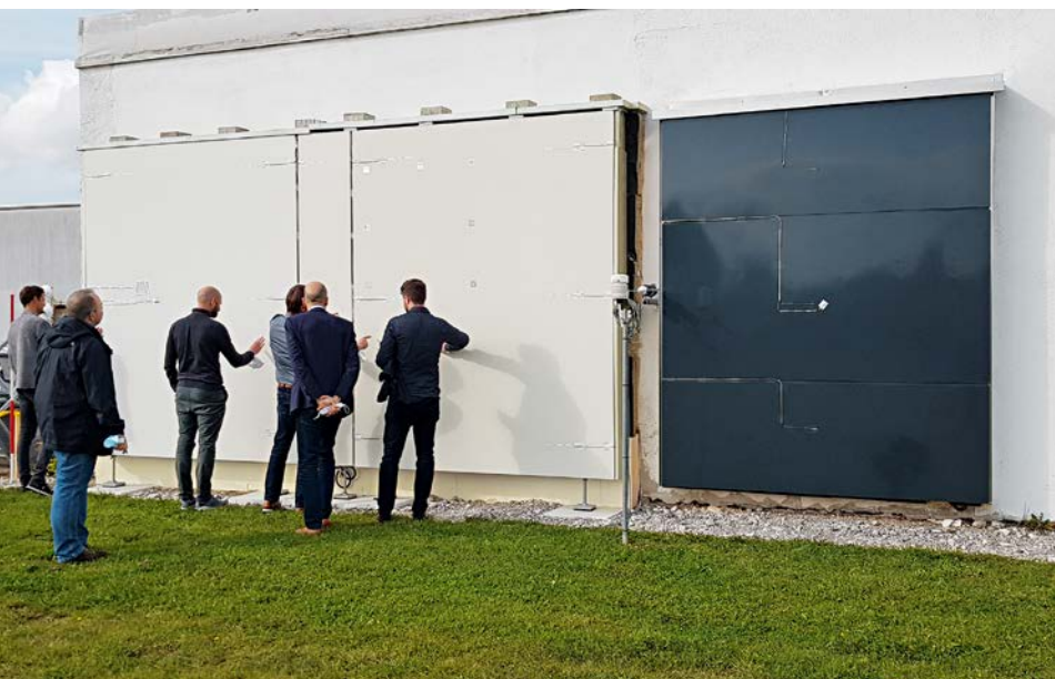
Solarthermie an vorgehängten hinterlüfteten Fassaden wird vom Fraunhofer IBP getestet
