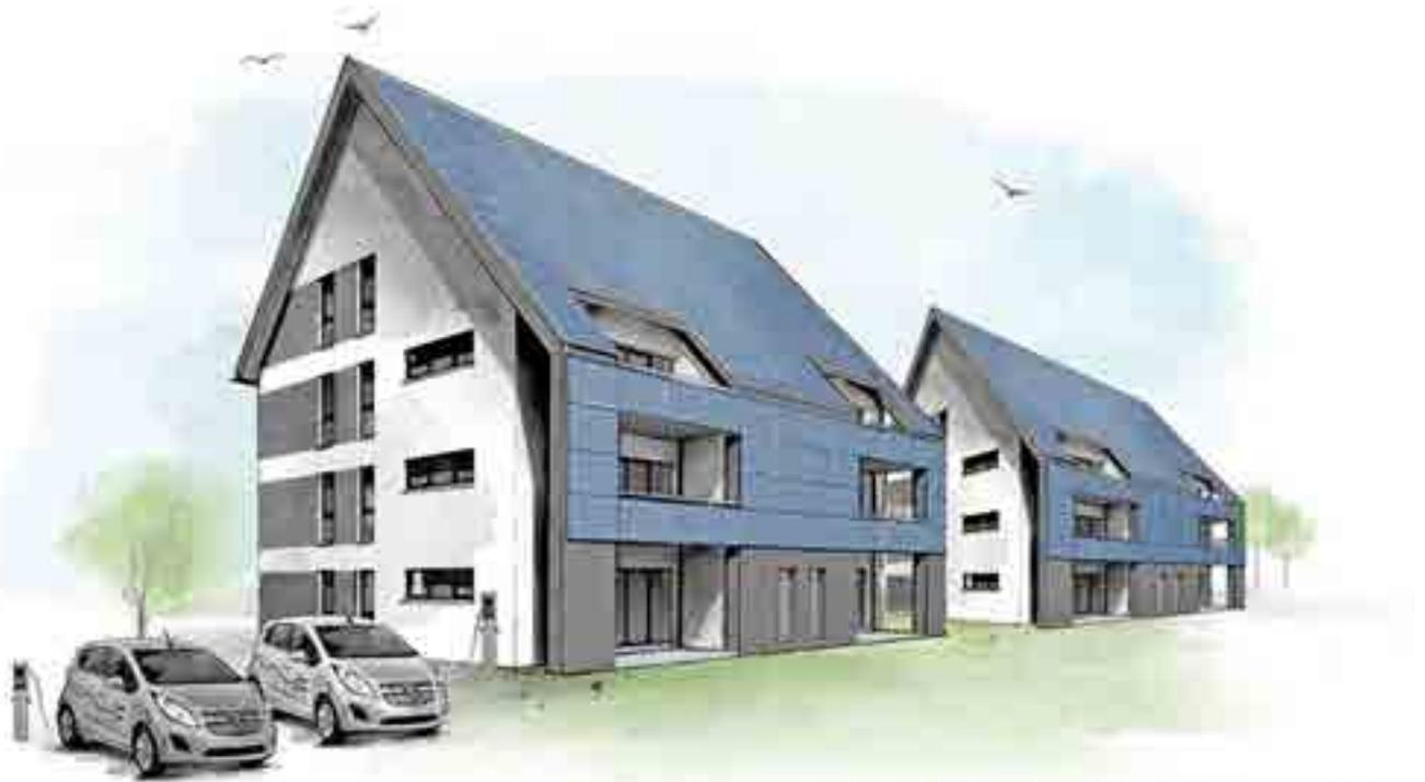
Bei dem Projekt der eG Wohnen 1902 ist der Neigungswinkel der Dächer speziell auf die solare Produktion im Winter ausgerichtet
