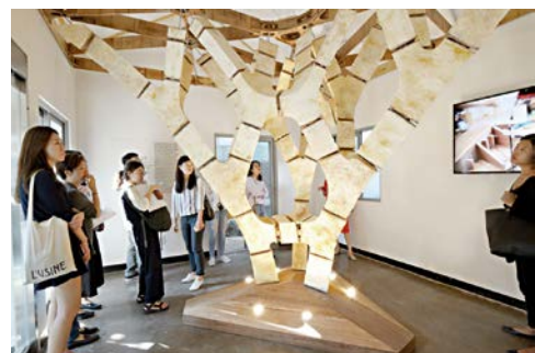
Der „Mycotree“ besteht aus einer Struktur aus Pilzmyzelium und Bambus und wurde erstmals bei der Seoul Biennale of Architecture and Urbanism 2017 gezeigt
