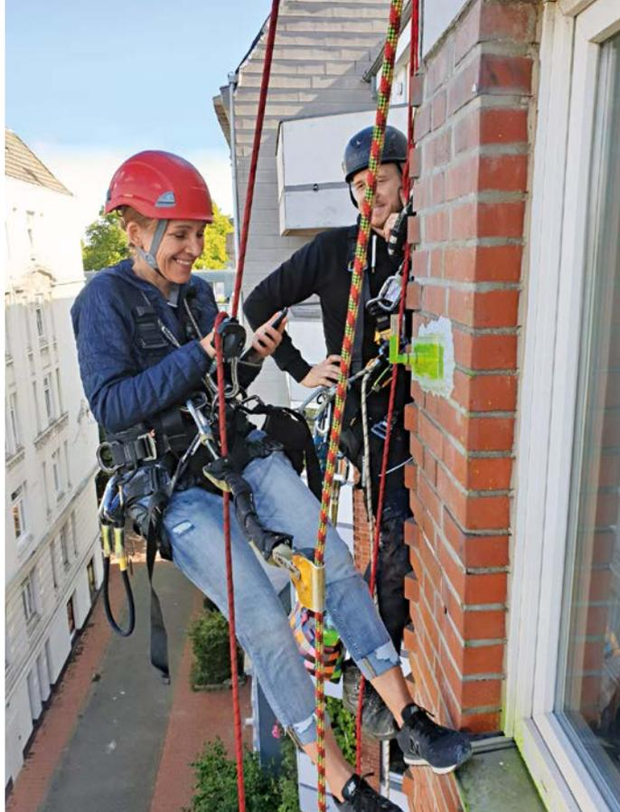
Bild 5: Prüfen der Schlagregendichtigkeit mit der „Franke-Platte“
