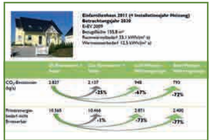
Vergleich der Heizungssysteme im Neubau von 2011: Wärmepumpe spart rund 70% nicht erneuerbare Primärenergie und CO 2
