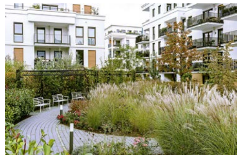
Über Tiefgaragen wachsen Gräser – tiefwurzelnde Pflanzen können hier nicht gesetzt werden
