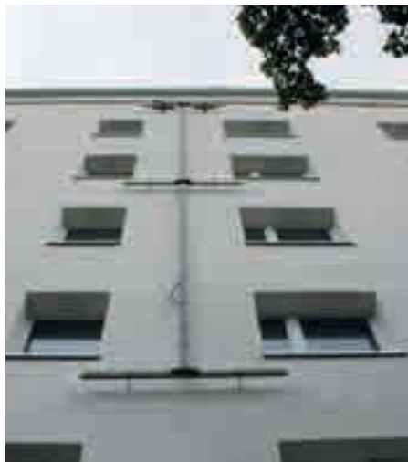
Mit dieser unscheinbaren Konstruktion werden Parameter wie Temperatur, Feuchtigkeit, Windrichtung und -intensität, Strahlungsintensität und Verdünnungseffekte gemessen.
